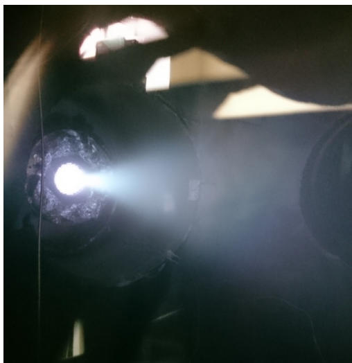
Рис. 1. ВЧ ионный двигатель с диаметром газоразрядной камеры 5 см во время работы. Светлые пятна — блики на стекле смотрового окна вакуумной камеры
